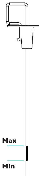
El aceite debe estar dentro del rango de operación correcto para que el amortiguador funcione correctamente.
