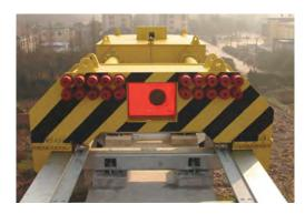
一般用于低速测试线路,设计目的:消减中心冲击力和侧面冲击力。固定式终点止动器设有 Oleo 液压装置(两台 Oleo Type 718 型装置,可复原行程: 1800mm)。安装长度: 5.5m, 冲击容量: 2016kJ。
