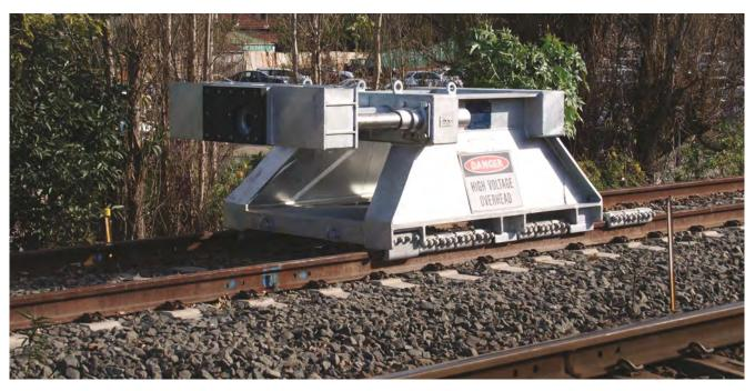
一般用在铁路主干线,设计目的:仅消减中心冲击力。带 9 对摩擦瓦和前端设有 I 对防攀移瓦的滑动摩擦式终点止动器。设有 Oleo 液压装置(两台 Oleo Type 9 型装置,可复位行程 400mm)。列车质量: 535 吨,冲击速度: 25 km/h,安装长度: I6 m,冲击容量: 448 kJ。
