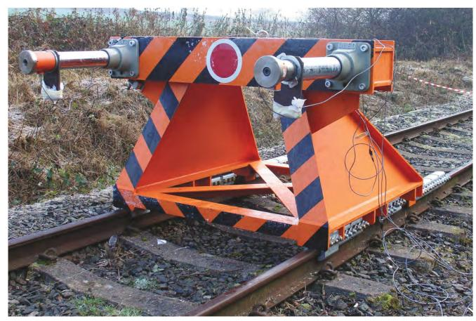
一般用于欧洲干线铁路(货运线路)上,设计目的:仅消减侧面冲击力。滑动摩擦式终点止动器(8 片摩擦瓦),设有 Oleo 液压装置(两台 Oleo Type 9 型装置,可复原行程 400mm)。列车质量: 220 吨,冲击速度: 25 km/h,安装长度: 25 m,冲击容量: 448 kJ。
