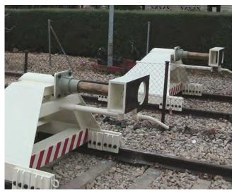
用于马德里地铁 5000 型、6000 型、7000 型、8000 型和 9000 型系列列车。安装了 Oleo 液压装置(一台 Type 9 型装置,可复原行程为 400mm)。列车质量范围 I63 吨-216 吨。最大冲击速度 I5 km/h。安装长度: 7.1 m。冲击容量: 224 kJ。
