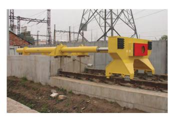
一般用于地铁和主干线,旨在消减中心冲击力和侧面冲击力。设有Oleo 液压装置的混凝土基础(两台 Oleo Type 724 型装置,可复原行程: 2400mm)。列车质量: 300 吨,冲击速度: I4km/h,安装长度:8m,冲击容量: 2688kl。
