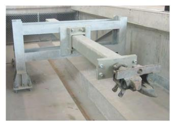
此项目需要客户自己设计安装在混凝土基础上的钢结构。设计目的:仅消减中心冲击力,设有 Oleo 液压装置(两台 Oleo Type 76 型装置,可复原行程: 1200mm)。列车质量: 115 吨,冲击速度: 8km/h,安装长度: 3.5m,冲击容量: 672kJ,边端力: 700kN。
