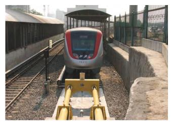
一般用于地铁和主干线,旨在消减中心冲击力和侧面冲击力。 设有 Oleo 液压装置的混凝土基础(两台 Oleo Type 730 型装置, 可复原行程: 3000mm)。列车质量: 510 吨,冲击速度: 12km/h, 安装长度: 9.5m,冲击容量: 3360kJ。
