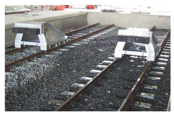
列车质量: 450 吨, 冲击速度: 15 km/h, 有 8 对摩擦瓦, 安装长度: 15 m。
