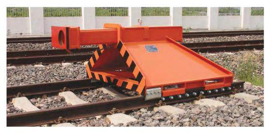
一般在"线路终点"处使用,设计目的: 仅消减中心冲击力。固定式终点止动器设有 Oleo 液压装置(一台 Oleo Type 76 型装置,可复原行程: 600mm)。列车质量: 300吨,冲击速度: 5km/h,安装长度: 2.8m, 冲击容量: 336k]。
