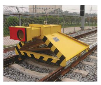
一般用于地铁线,设计目的: 仅消减中心冲击力。滑动摩擦式终点止动器(20 片摩擦瓦),设有 Oleo 液压装置(一台 Type 9 型装置,可复原行程 400mm)。列车质量: 220 吨。冲击速度: 25km/h。安装长度: 16m。冲击容量: 224kJ。
