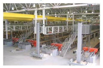
一般用于地铁、主干线和调车场,旨在消减中心冲击力和侧面冲击力。设有 Oleo 液压装置的混凝土基础(三台 Oleo Type 712 型装置,可复原行程:I200mm)。列车质量:I000 吨,冲击速度:I.94m/s,冲击容量:2016kJ,安装长度:3.5m。
