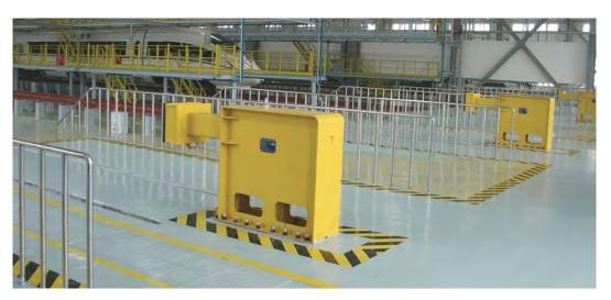
一般用于调车场/维修厂,设计目的:仅消减中心冲击力。固定式终点止动器设有 Oleo 液压装置(一台 Oleo Type 76 型装置,可复原行程: 600mm)。安装长度: 2.7m,冲击容量: 336kJ。
